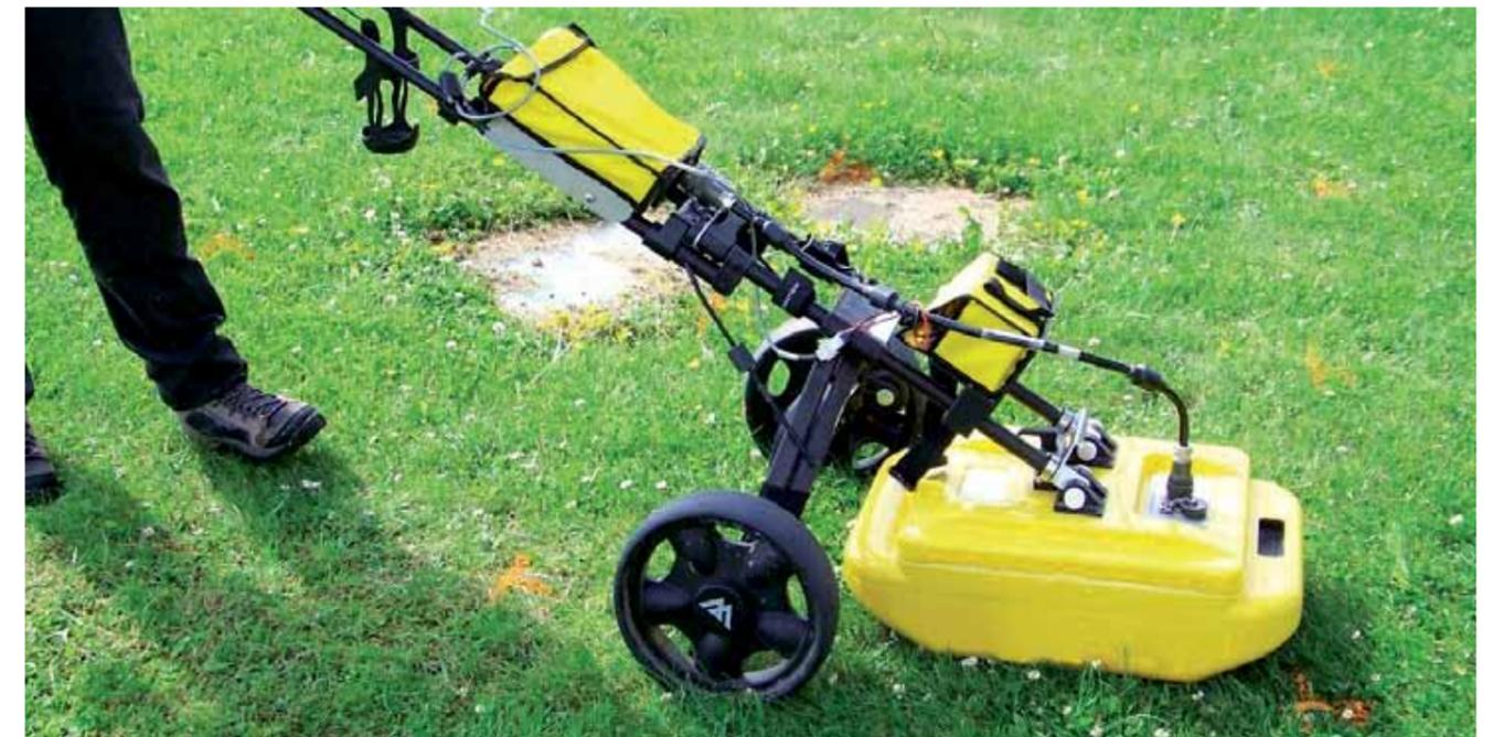
Photo d'un radar basse fréquence en opération.
