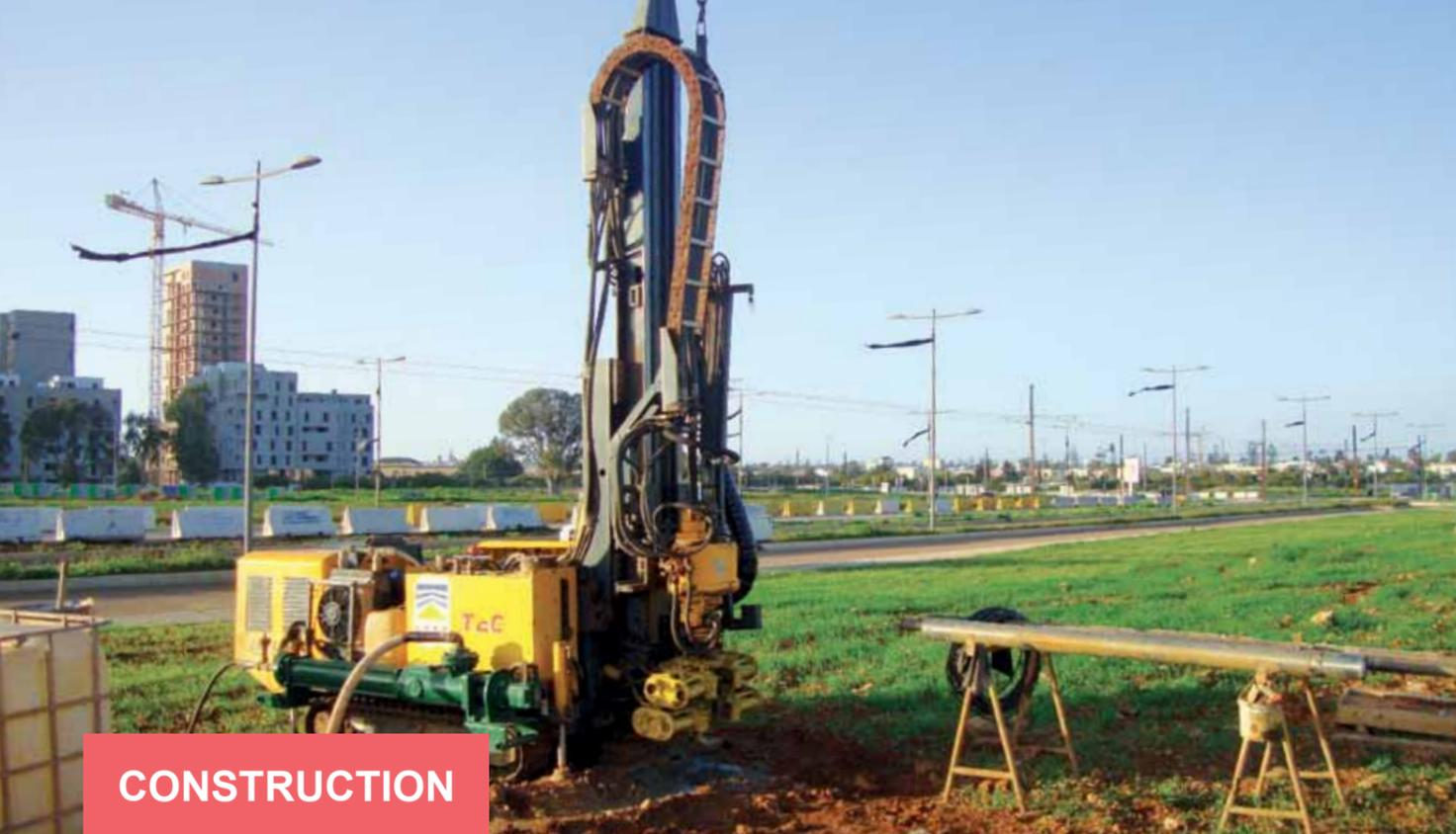
Une partie du matériel de sondages utilisé sur le chantier.
